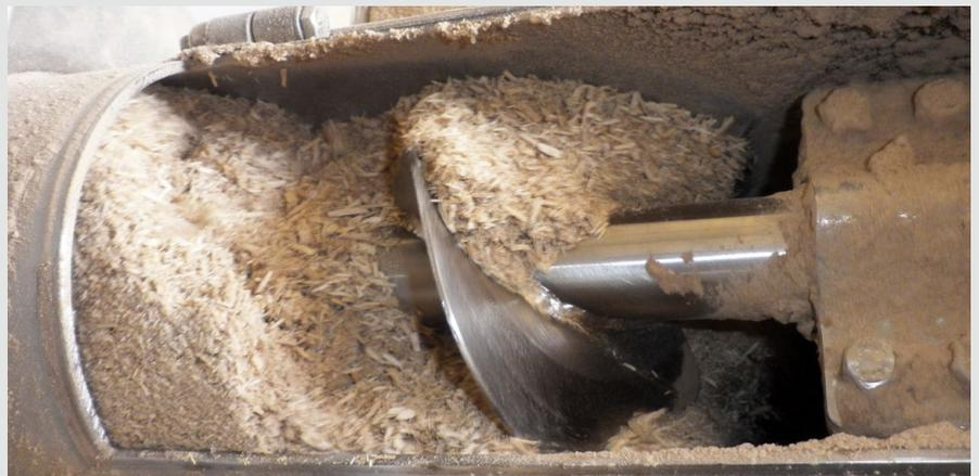
Schneckenverdichtereinheit zur Montage an Übergabestellen oder Fallschächten
