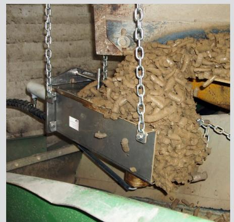
Verdichtereinheit, vorrangig zur Messung von Lehm und Ton
